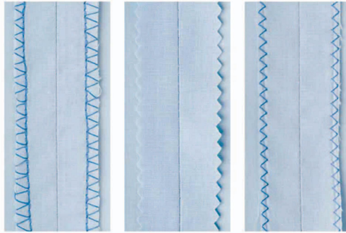
Gambar 1.1 Kampuh Terbuka dengan penyelesaian obras, gunting zig zag dan setikan zigzag (Smith, 2011)
